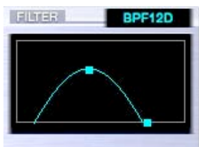
Der „Bandpaßfilter“ (BPF) gehört zu den klassischen Filter-Typen.
