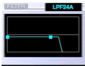
24dB-Filter-Typen haben eine größere Flankensteilheit
