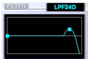
Die hier eingestellte maximale Filter Gain von 255 bei hoher Resonance kann schnell zu unangenehmen Verzerrungen führen.
