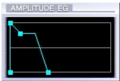
Beispiel 2: Die Veränderung der Attack Time von 64 auf 0 macht aus dem Synthstrings-Sound einen Synthcomp-Sound ohne Anschlagzeit
