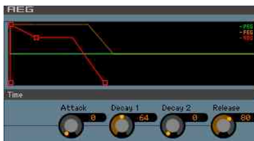
Beispiel 2: Die Veränderung der Attack Time von 64 auf 0 macht aus dem Synthstrings-Sound einen Synthcomp-Sound ohne Anschwellzeit
