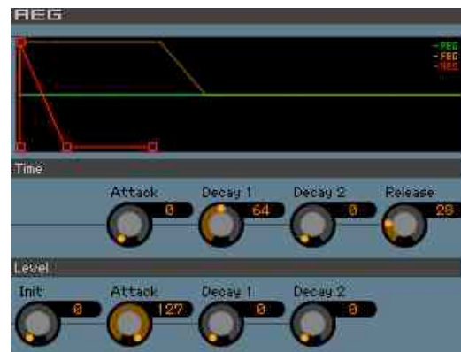
Beispiel 3: In dieser perkussiven ADSR-Envelope sind beide Decay-Level auf 0 gesetzt. Die Release Time ist sehr kurz, während die Decay1 unverändert bei 64 liegt.
