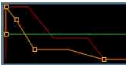
Abbildung 2: Richtig eingestellte Amp-Envelope (rot). Die perkussive Filter-Envelope (gelb) kann sich voll entfalten.
